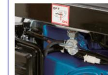
バルブの開閉により、LPガスとガソリンの燃料切替えを行います。
